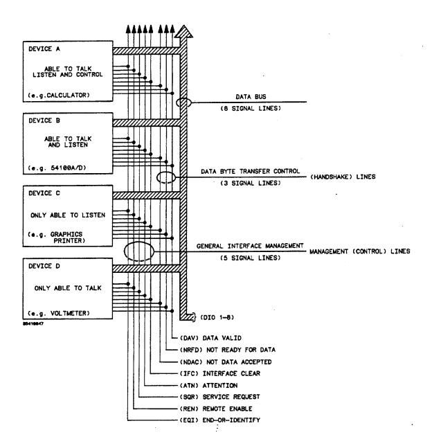
Figure 4-5. HP-IB Interface
