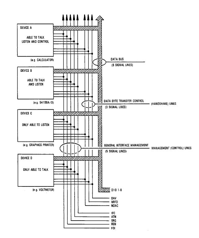
Figure 4-5. HP-IB Interface
